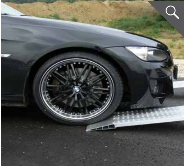
Geringer Auffahrwinkel an den Auffahrschienen 7°
