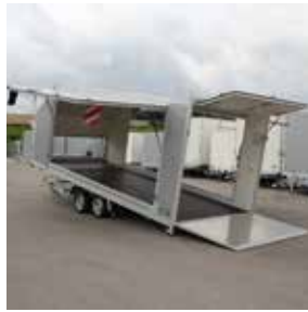
Ladefläche kippt durch Schwerpunktverlagerung oder hydraulisch für eine schnelle Beladung
