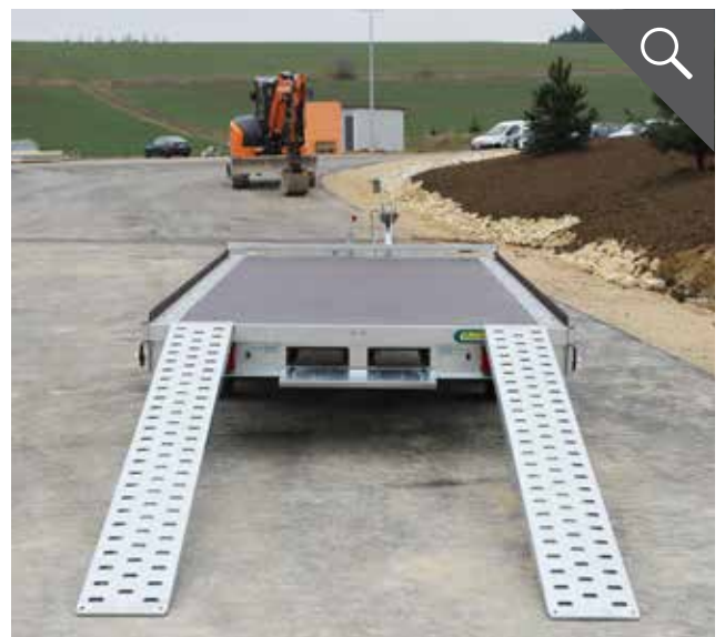
Auffahrsschienen mit 2400 - 2725 kg/ Paar Tragkraft (je nach Modell)
