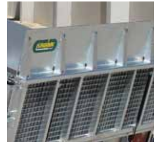
Durchgehende Stahlgitterauffahrklappe mit Alu-Riffelblech belegt
