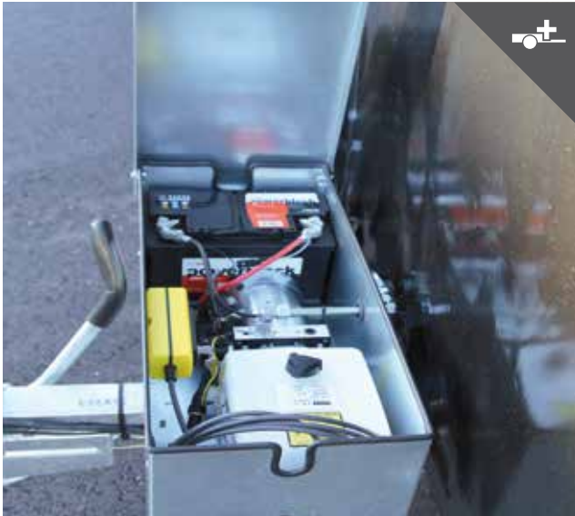
Leistungsstarke Elektrohydraulik wasser- und schmutzgeschützt montiert
