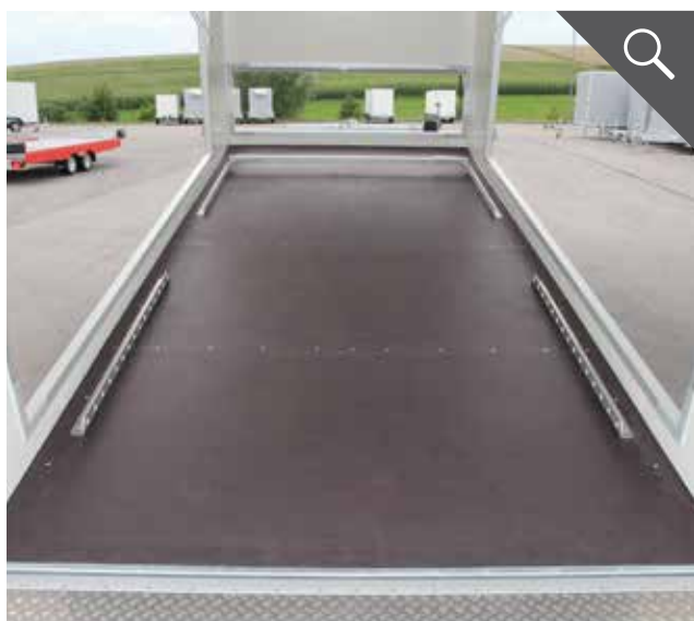
Integriertes Zurrsystem für eine einfache Ladungssicherung
