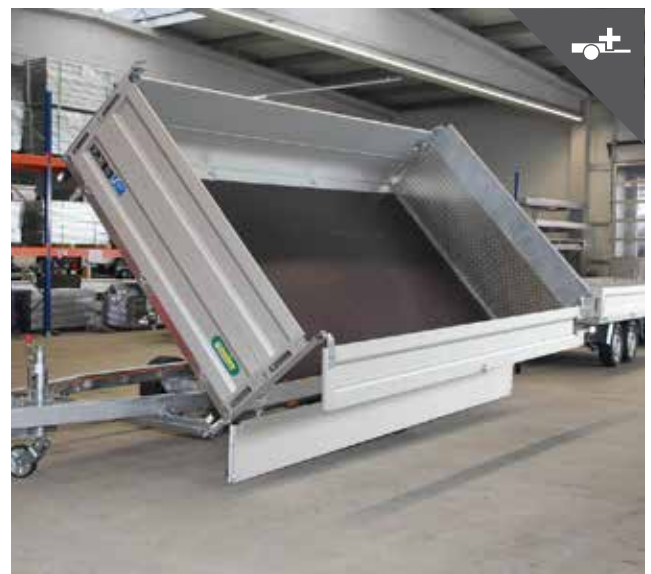
Bordwandaufsatz für mehr Ladevolumen
