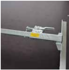
Integriertes Zurrsystem für einfache Ladungssicherung
