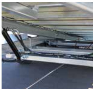
Ladefläche kippbar durch Schwerpunktverlagerung
