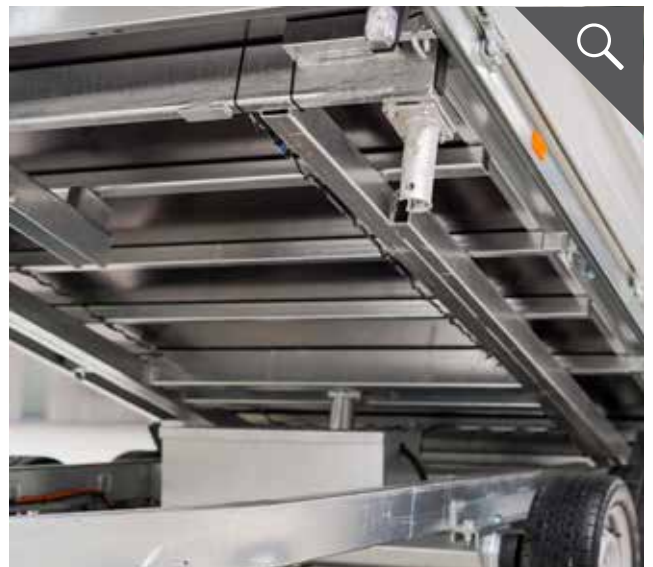
Verschweißter und feuerverzinkter Stahlrahmen
