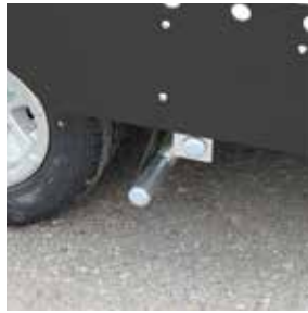
Einfache Entriegelung der Auffahrschienen durch Quickstop-Fußbetätigung
