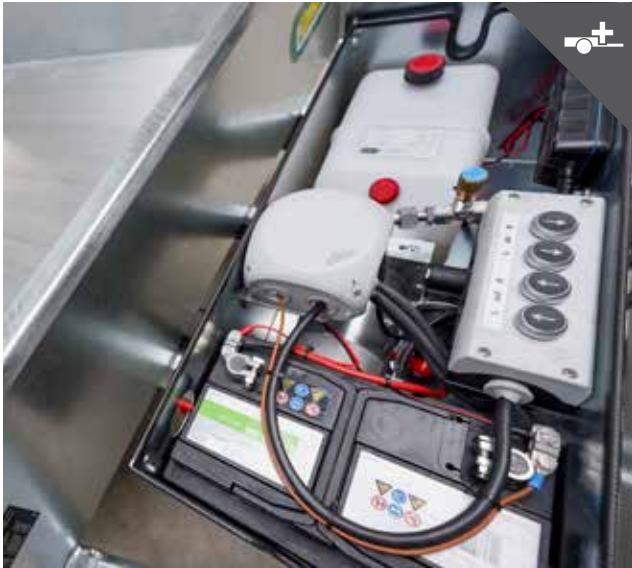
Leistungsstarke Elektrohydraulik wasser- und schmutzgeschützt
