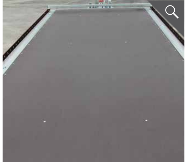
Durchgehende Bodenplatte ohne Stoß (18 mm)
