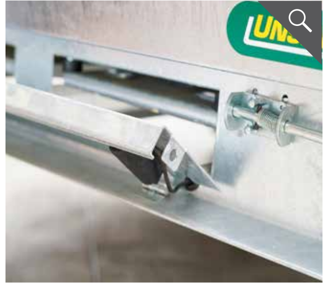
Abklappbarer Kennzeichenhalter zum eleganten Verstauen der Auffahrschienen
