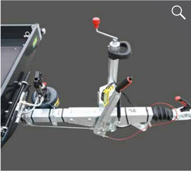
Verstärktes und automatisches Stützrad mit Rangiergriff
