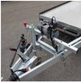
Verschweißter und feuerverzinkter Stahlrahmen
