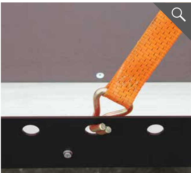
Zurpunkte in der Seitenreling für flexible Ladungs-sicherung, jeweils mit 400 daN belastbar
