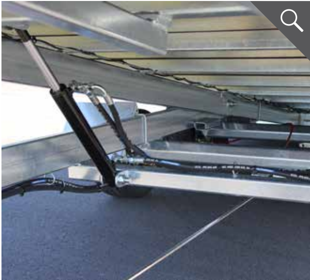
Doppeltwirkende Hydraulikzylinder für sicheres Beladen
