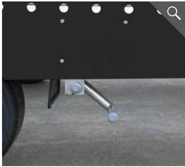
Quickstop-Fußbetätigung zum Entriegeln der Auffahrschienen
