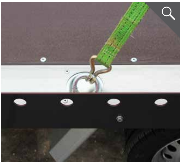
Zurmulden versenkt im Bodenrahmenprofil mit jeweils bis zu 600 daN belastbar
