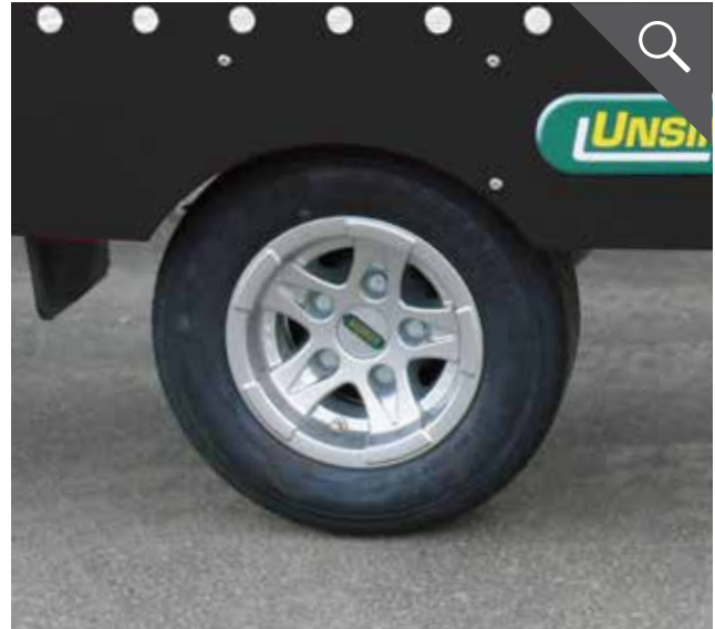
10 Zoll Bereifung für eine niedrige Ladehöhe
