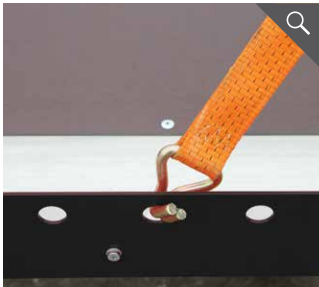
Zurrpunkte in der Seitenreling mit 400 kg belastbar
