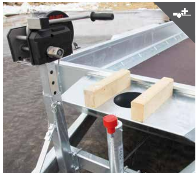
Baggerarmauflage, Windenbock mit Handseilwinde
