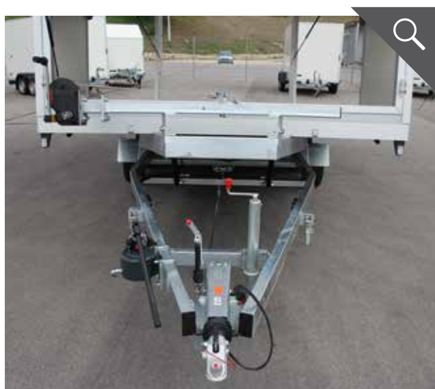
Fahrgestell aus verschweißter und feuerverzinkter Hohlprofilkonstruktion
