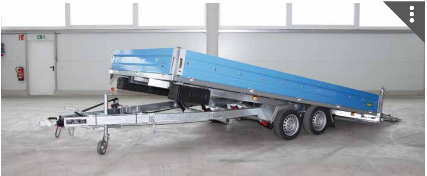
Pulverbeschichtete Bordwände in RAL nach Wunsch
