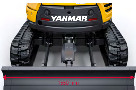
AUSGEFAHREN: MEHR STABILITÄT FÜR VERBESSERTE GRAB- UND LADELEISTUNG
