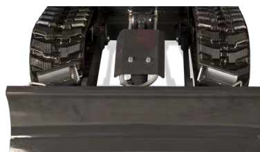
Eingefahrener Unterwagen: 955 mm
