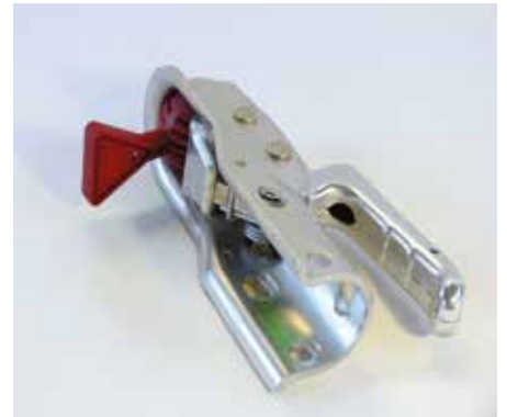
Kugelpkupplung mit Safety-Ball
