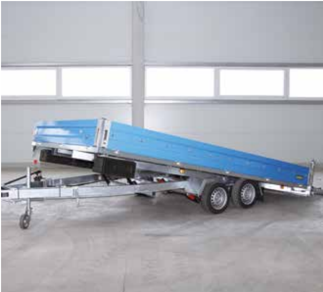
Pulverbeschichtete Bordwände Typ PKL
