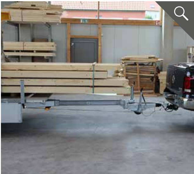
Maximale Zugdeichsellänge von 3.100 mm im Standard
