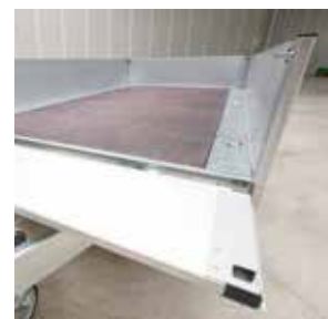
Eloxierte Aluminium-Bordwände vierseitig abklapp- und abnehmbar
