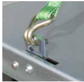
6 versenkte Zurringe mit je 600 kg Zugkraft
