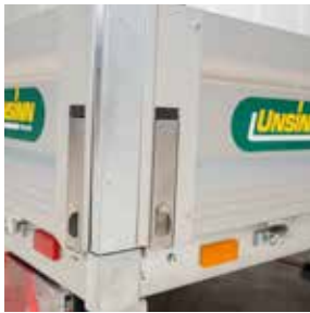
Versenkte Bordwandverschlüsse aus Edelstahl
