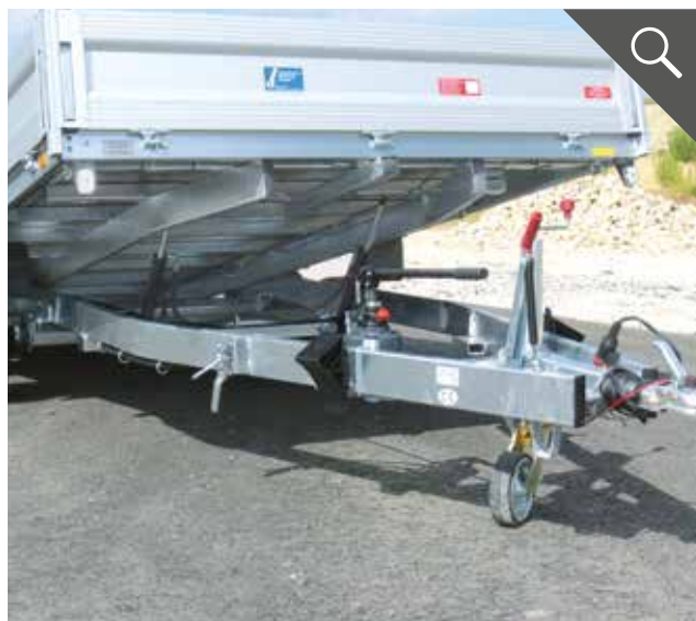
Verschweißter und feuerverzinkter Stahlrahmen
