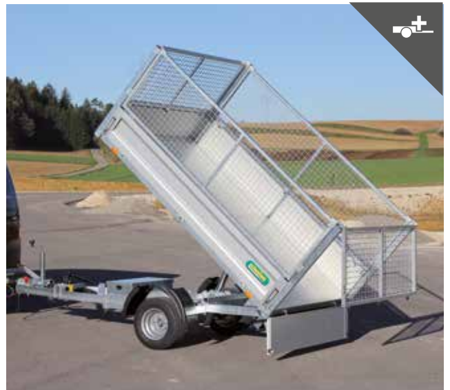
Welldrahtgitteraufsatz für mehr Ladevolumen
