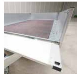
Eloxierte Aluminium-Bordwände vierseitig abklapp- und abnehmbar
