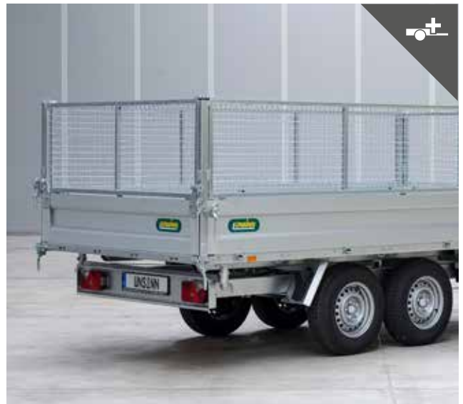
Welldrahtgitteraufsatz für mehr Ladevolumen
