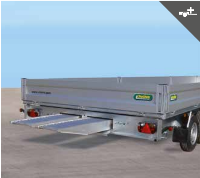
Halterung für Auffahrschienen unter der Ladefläche
