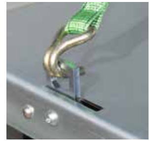
6 - 8 versenkte Zurringe mit je 600 kg Zugkraft
