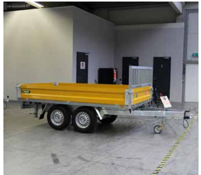
Pulverbeschichtete Bordwände Typ GTP
