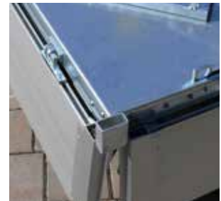
Alu-Bordwände vierseitig abklapp- und abnehmbar
