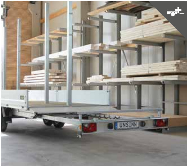
Heckleuchenträger bis 2000 mm ausziehbar
