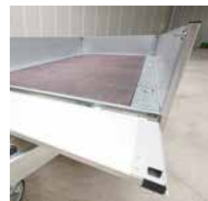
Eloxierte Aluminium-Bordwände vierseitig abklapp- und abnehmbar
