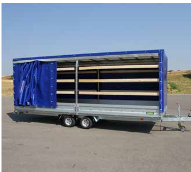
Planenaufbau mit Schiebeplane in blau RAL 5002
