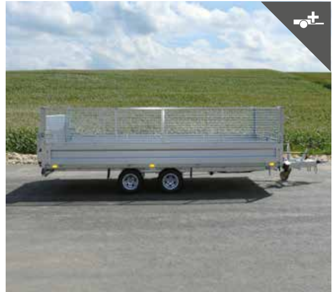
Welldrahtgitteraufsatz für mehr Ladevolumen
