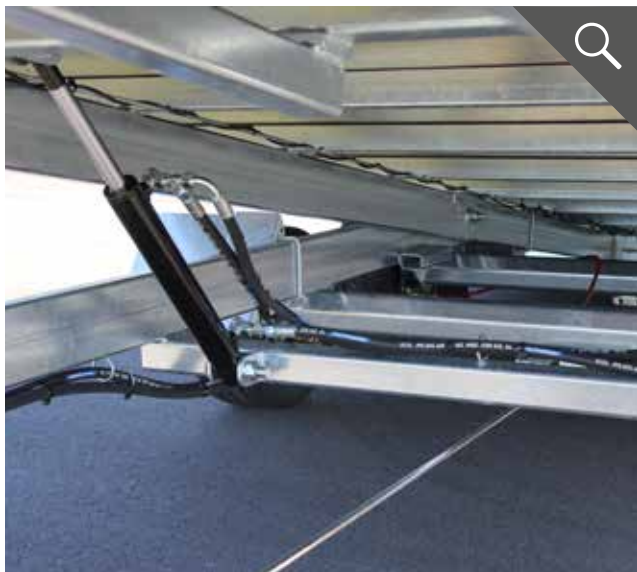
Doppeltwirkende Hydraulikzylinder für sicheres Beladen
