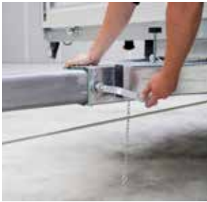
Rohrzugdeichsel werkzeuglos ausziehbar
