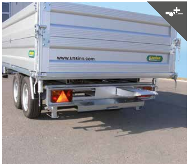
Alu-Auffahrschienen und Bordwandaufsatz für mehr Ladevolumen
