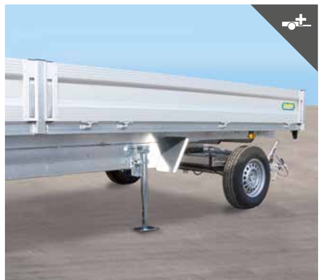
Kurbelstütze für einen sicheren Stand
